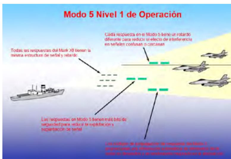
Nivel 1 de funcionamiento IFF-5, con mejoras técnicas
