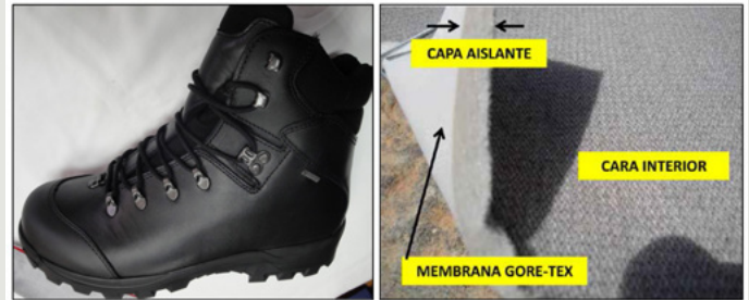
Izda: Bota para frío de montaña. Dcha: detalle del forro interior aislante con Gore-tex
