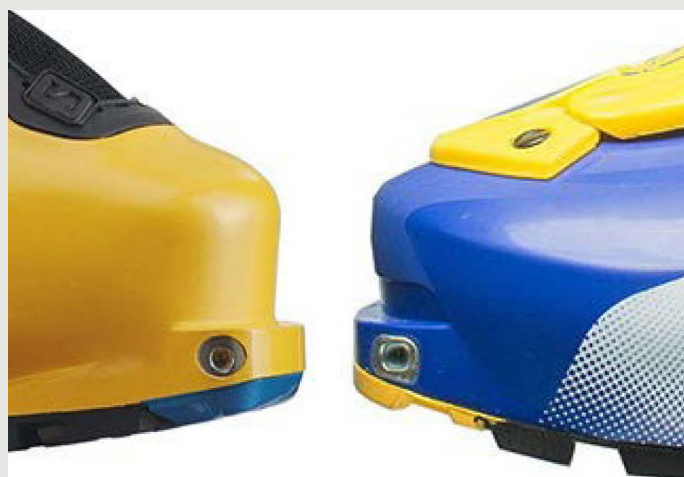
A la izda., bota válida para fijación TECH (insertos metálicos) y también compatible con fijación de chasis (saliente en la puntera > 5 mm). A la dcha., bota sólo compatible con fijación TECH (saliente en la puntera < 5 mm).
