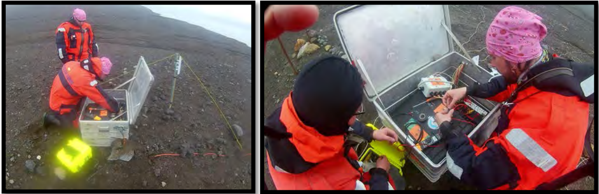
Comprobación del correcto funcionamiento de estaciones sísmicas
