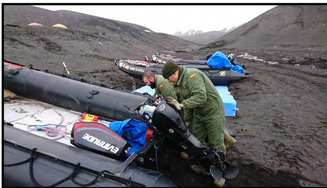
Distintas actividades cotidianas en el día de hoy, navegación arreglando módulo, sanidad revisando equipo, motores mantenimiento de embarcaciones
