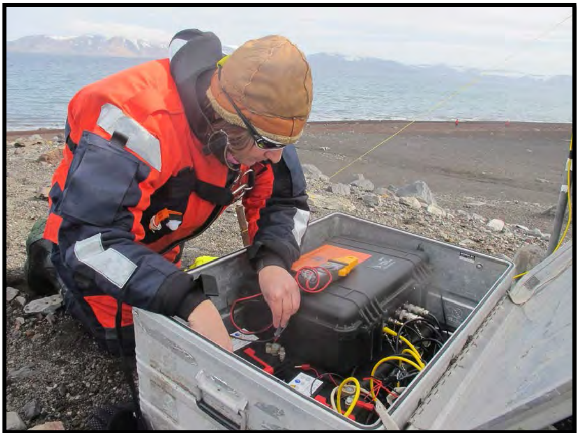
Revisión de estación sísmica
