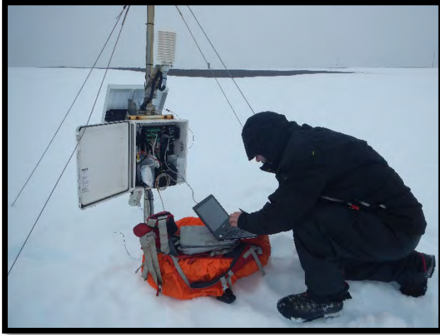
Descarga datos de estación PERMASNOW e instalación de antena en módulo científico
