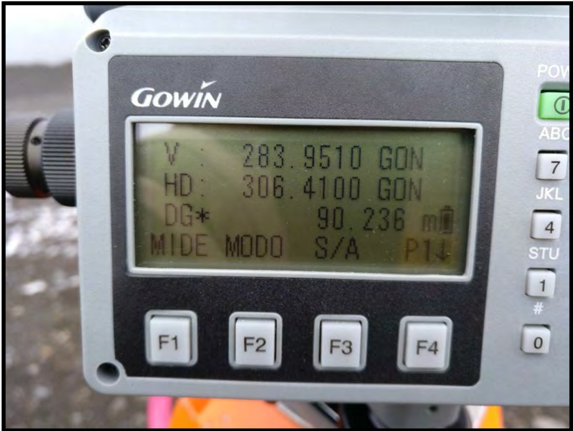
Lectura angular de uno de los puntos en el levantamiento topográfico
