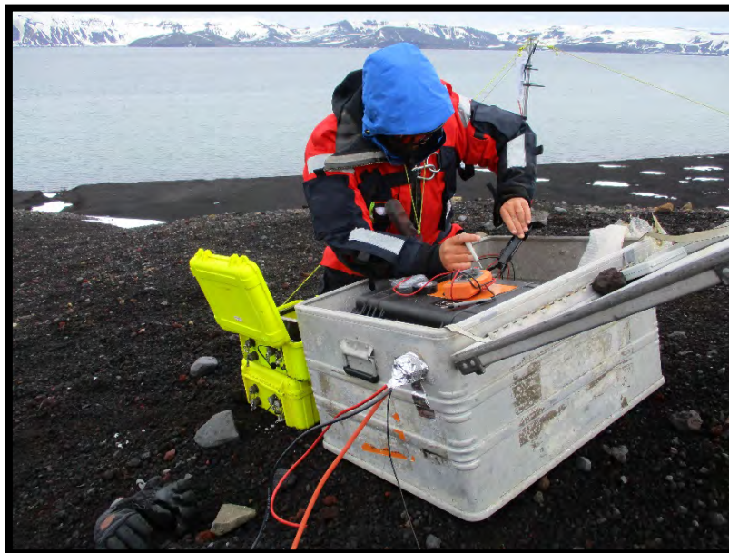
Comprobación de estación sísmica en Obsidianas
