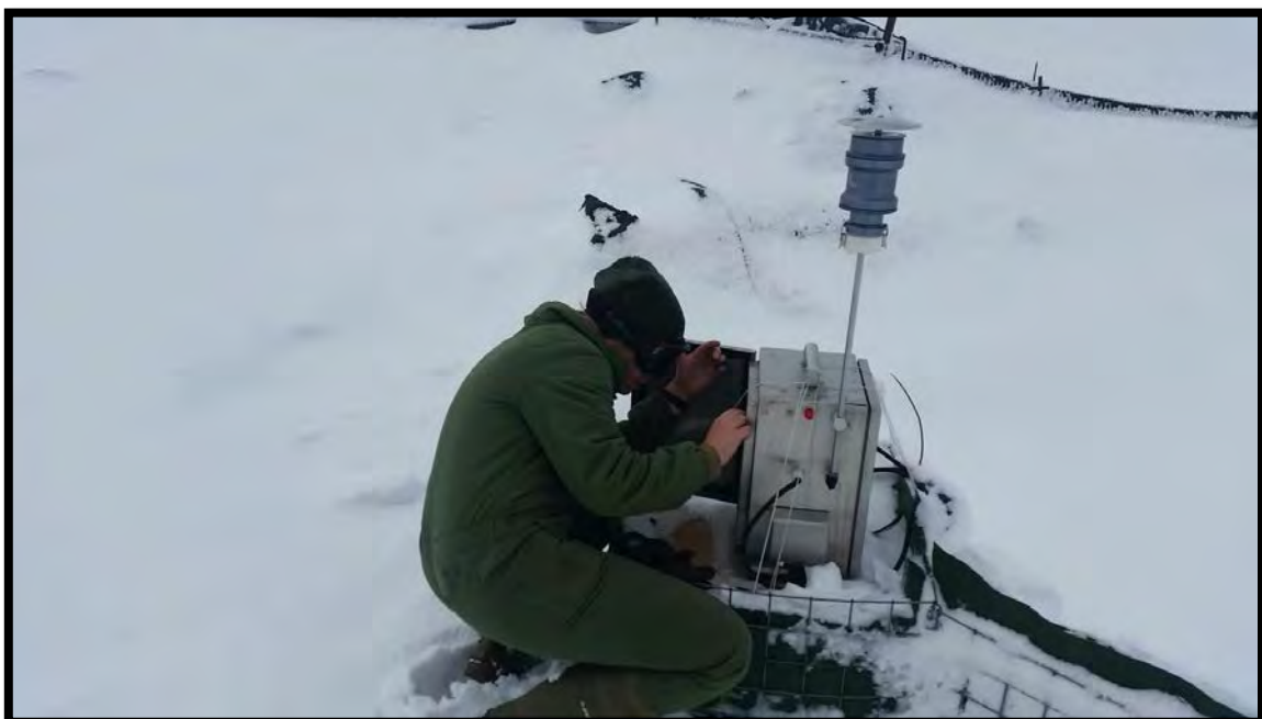
Retirada del captador de aerosoles
