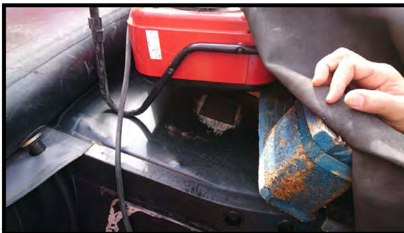
Reparación de un roto en el suelo de una zodiac
