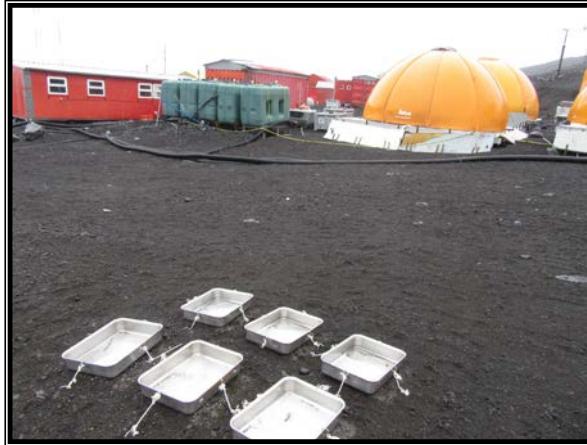
Captadores de lluvia
