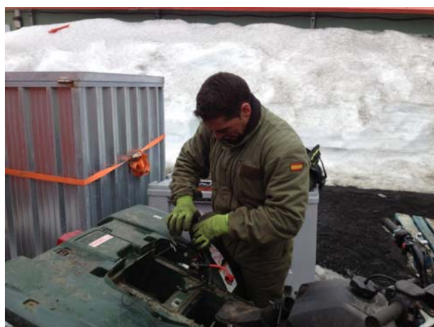
Desmontaje del Quad de ruedas para la reparación del tubo de escape, sustitución completa de los frenos y carenados.
