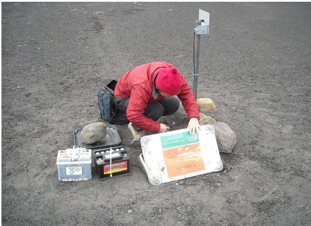
Trabajo de cambio de baterías en las estaciones del equipo de SEGAVDEC-SÍSMICA.
