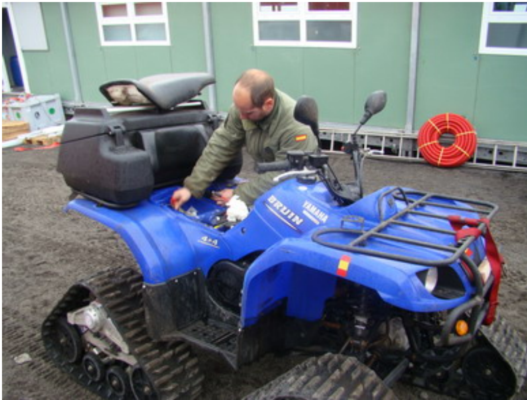
Trabajos de reparación del motor de arranque del quad con sistema de tracción oruga.
