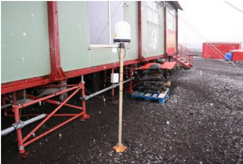
Terminal Satélite Inmarsat BGAN NERA WORLDPRO 1000 sobre radomo de Mini-m marino
