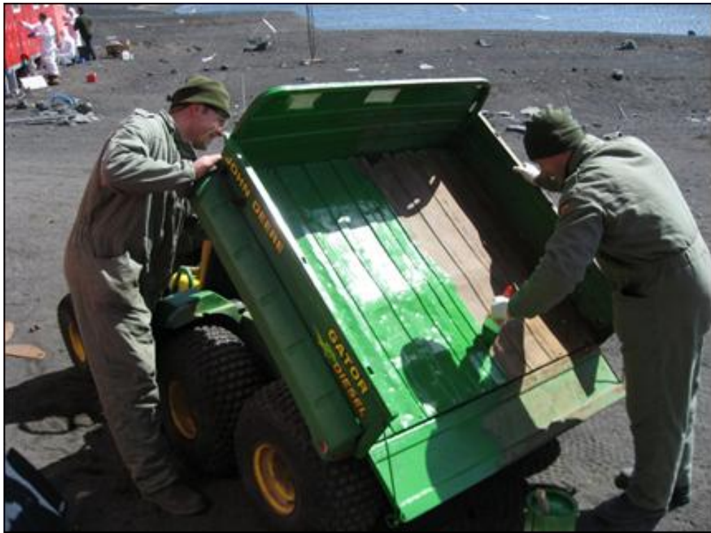
Pintado de verde y reparaciones de chapa en la moto John Deere num. 1
