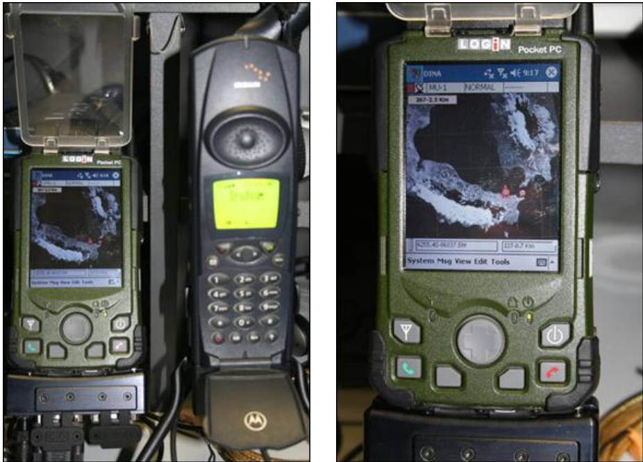
Vista de terminal satélite Iridium y PDA rugerizada con ortoplanimetría de Decepción.
