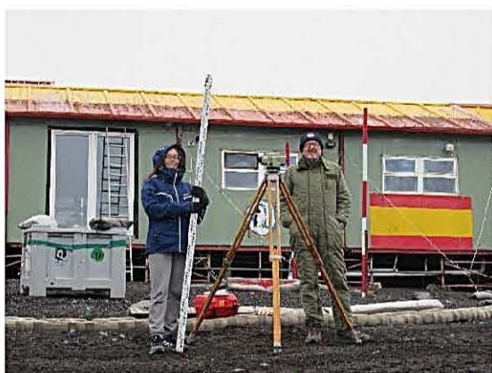
NIVELACION DE MARCAS DEL MURO
