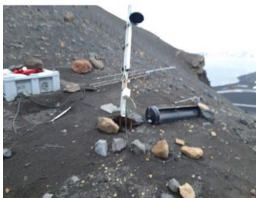
Desperfectos durante el invierno en el material de Cerro Caliente
