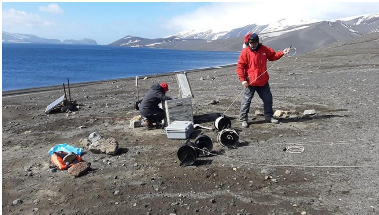
Instalación de array sísmico
