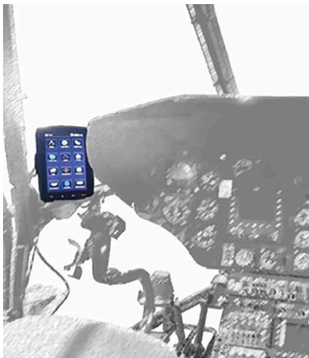
Representación de la disposición del GPS Garmin Aera 795 en cabina de HU21
