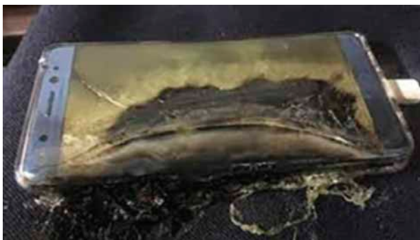
Imagen teléfono Samsung Galaxy Note 7 tras fuga térmica (Fuentes abiertas)
