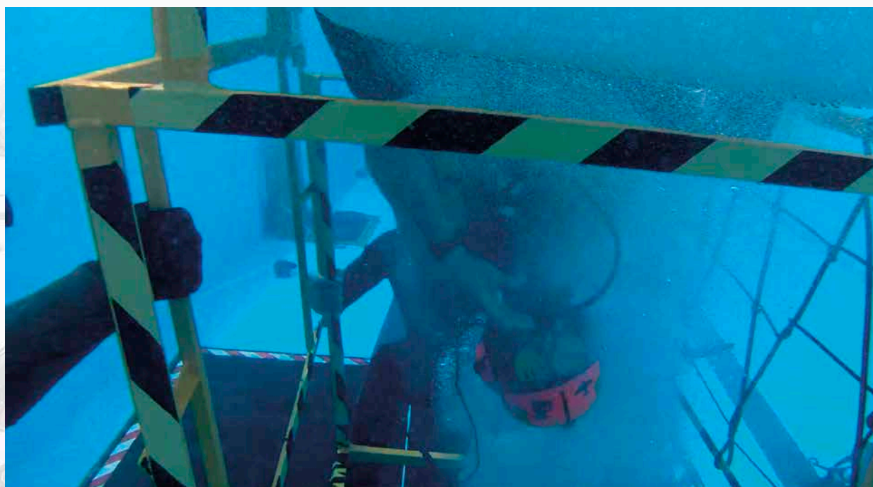
Entrenador de inversión. Un participante realiza un ejercicio de fuga bajo estrés (sin visión) con casco aeronáutico e interfonía mientras es monitorizado por dos instructores y un buceador de seguridad
