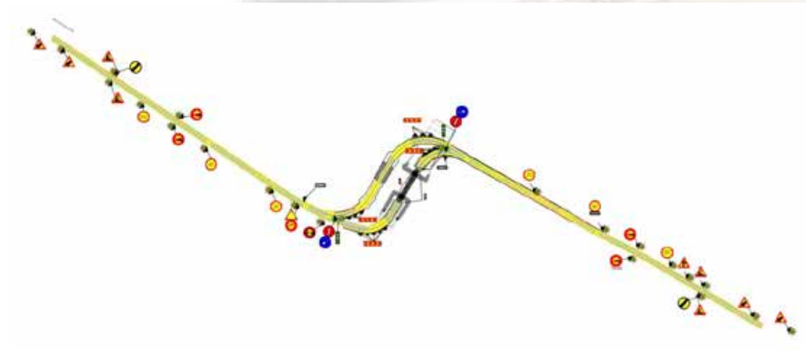
Ilustración 13. Señalización del Puente y sus accesos.
