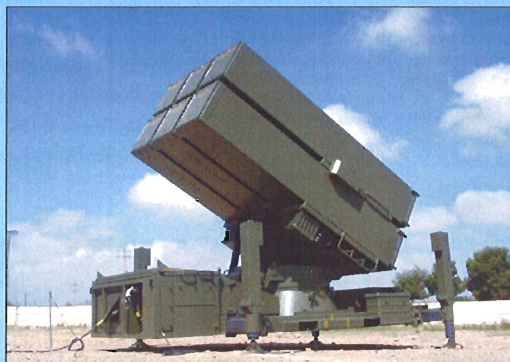
El lanzador del sistema cuenta con seis misiles
