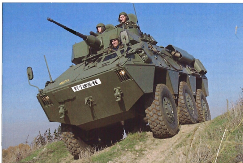
Un modernizado VEC en la pista de pruebas del PCMASA nº1. Se puede apreciar el nuevo dibujo bidireccional de la rueda
