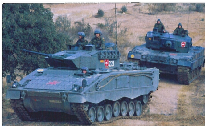
El "Pizarro" tiene un sistema de estabilización que le permite disparar en movimiento
