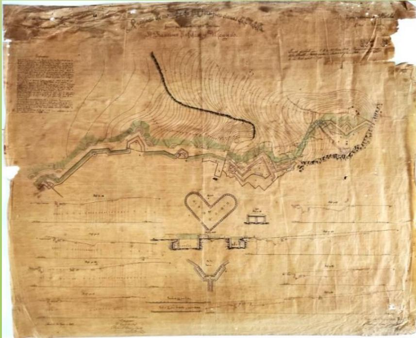
Para aumentar aún más su defensa se la rodea de un camino cubierto y de una galería envolvente de minas y de la cual parten los ramales y hornillos.
