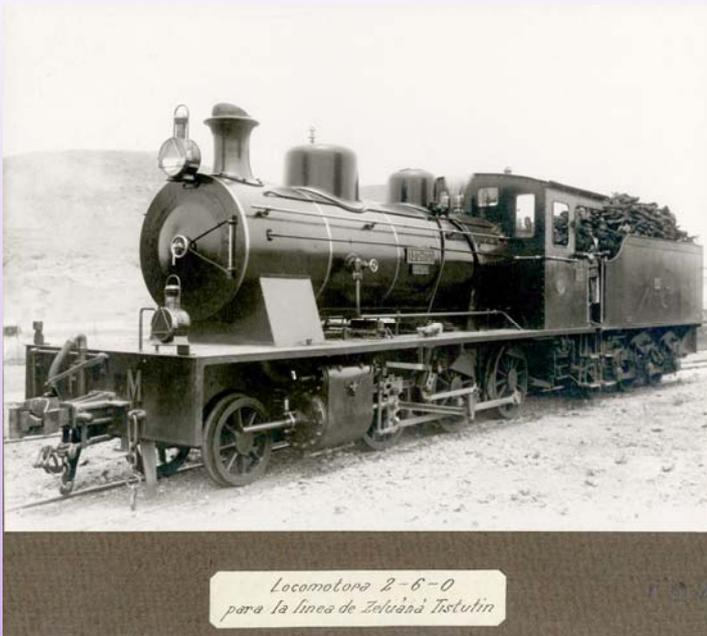
Locomotora 130+2T de los Ferrocarriles del Estado, construidas por MTM de Barcelona, para la línea Nador-Tistutin. Se adquirieron dos unidades”.
