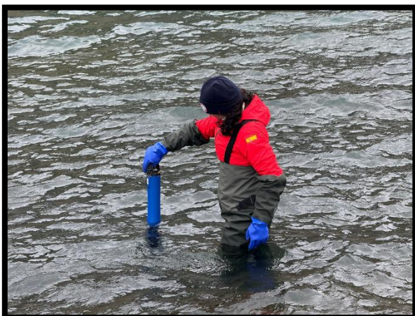
Susana utilizando la sonda para métrica EXXO para medidas de salinidad, pH y otros parámetros
