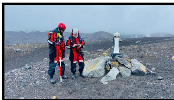
Comprobación de la recepción de correcciones RTCM
