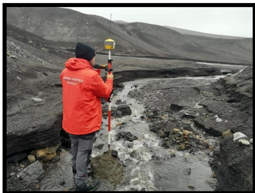
Manuel tomando puntos de control con GNSS
