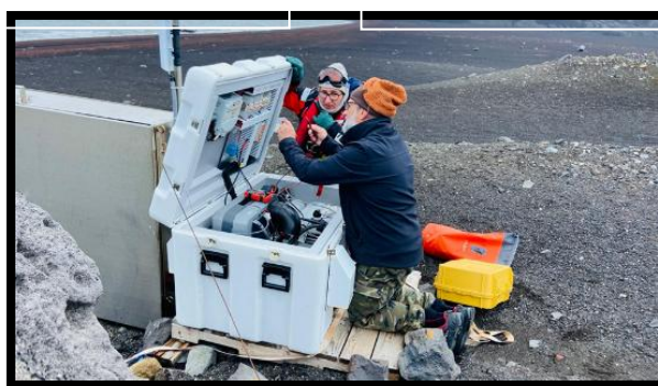
Vanessa y Rafa chequeando los niveles de la pila de metanol
