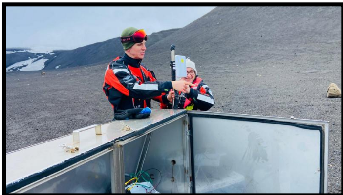
Pablo y Vanessa sustituyendo la antena WiFi de la estación de Cráter 70
