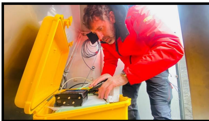
Configuración de los equipos de RTK
