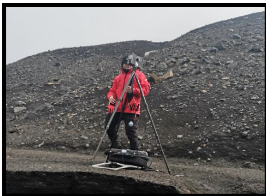
Manuel realizando mediciones con Laser Escáner de las neveras en la cabecera del Mecón
