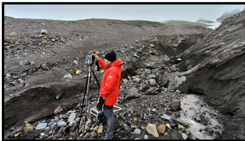
Manuel poniendo en marcha el lidar para el escaneo de la cabecera del Mecón
