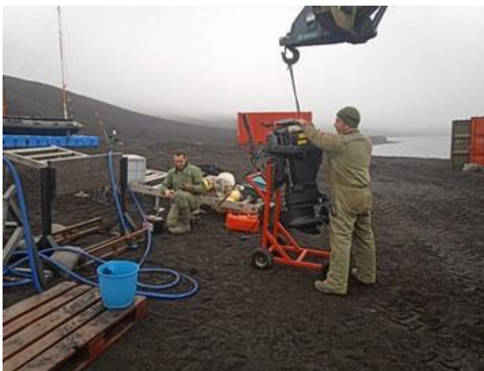
Pepe y Jorge del área de motores poniendo un motor fueraborda en estado de hibernación
