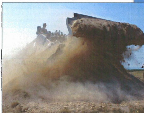
Arriba: el AEV 3 Kodiak puede superar todo tipo de obstáculos. Derecha: su sistema de excavación permite trabajar con diferentes herramientas —en este caso, la pala—.
