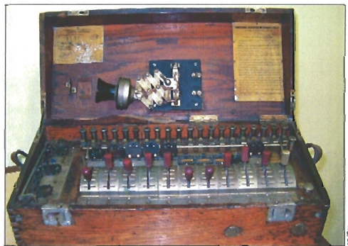
Una central telefónica de fabricación italiana
