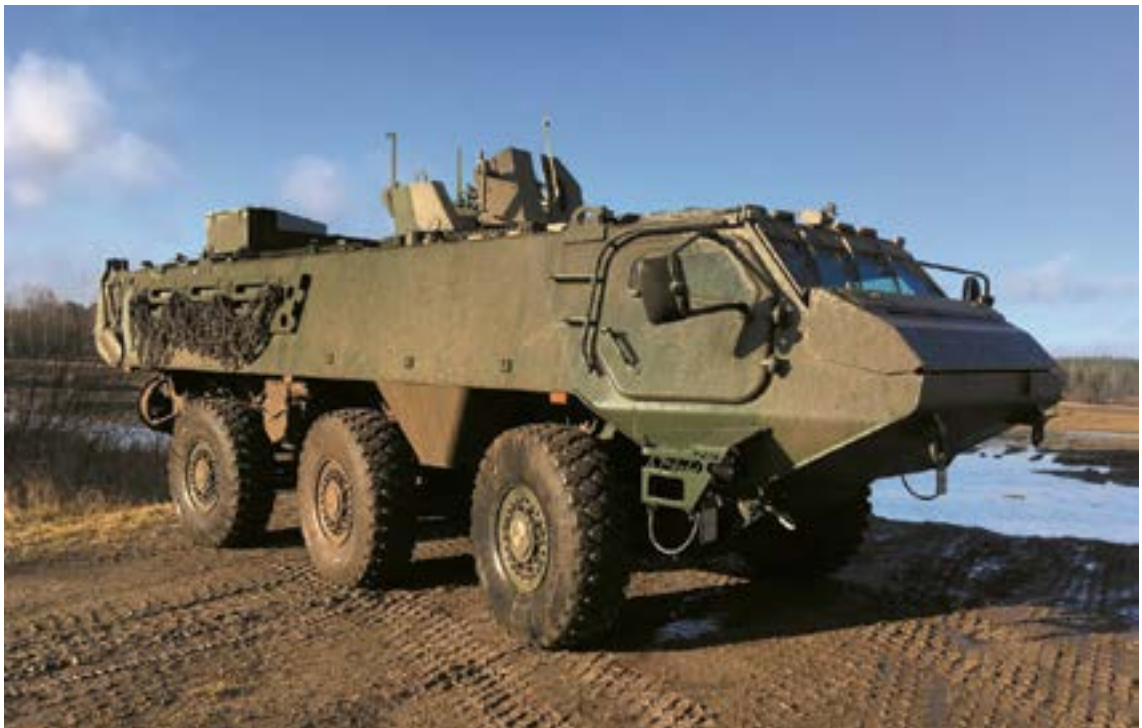
Patria CAVS 6x6 (nordicdefencereview.com). Nivel protección: munición cinética (medio-alto), minas (medio-alto). Movilidad: 400 CV - 16 CV/t. Tripulación: 2+10. Dimensiones: largo: 7,5 m, ancho: 2,9 m, altura sobre barcaza: 2,5 m. Peso 24.000 kg
