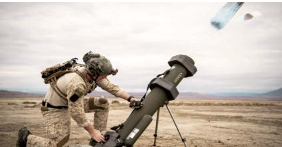
Munición Hero 120 con capacidad contracarro, peso de 14,5 kg y 60 minutos de autonomía (UVision)
