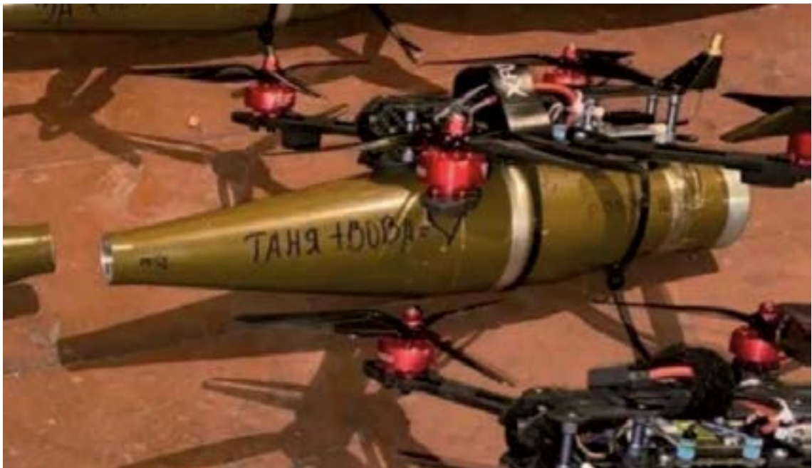
Dron letalizado con un proyectil carga hueca PG-7v (wikitanks)
