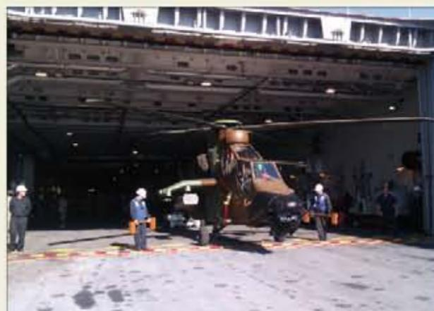
Para que el Tigre pueda subir a bordo hay que desmontar las palas (izquierda), izarlo con la grúa del buque hasta la cubierta (centro) y ubicarlo en el hangar (derecha)
