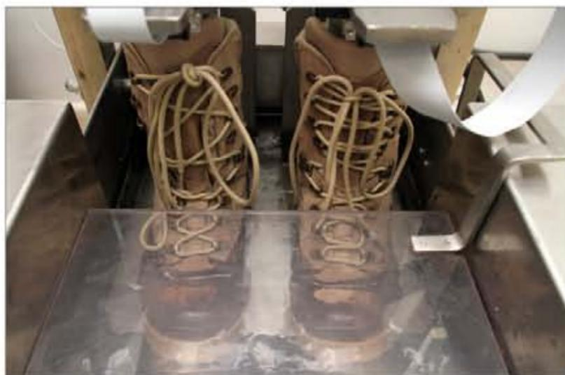
Óscar, el *bundesmann*, en la prueba del traje de tormenta (arriba). Ensayo de impermeabilidad de bota completa (izquierda). Característica fachada del edificio de la UEPL (abajo).
