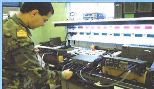
Los ajustes de la PR4G se llevan a cabo con el frecuencímetro
