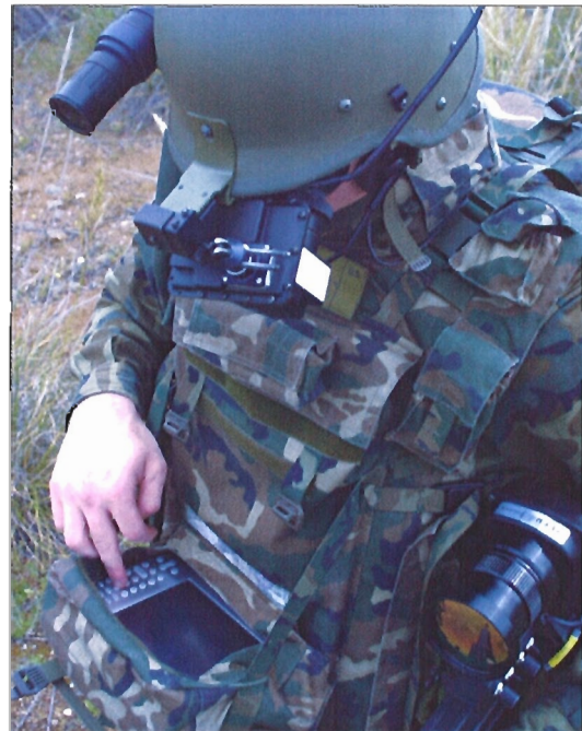
El soldado lleva un ordenador portátil conectado al visor del casco
