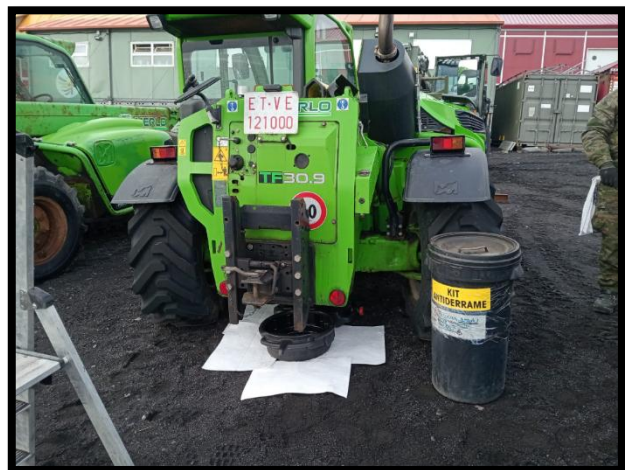
Reparación de la MERLO con medidas antiderrame
