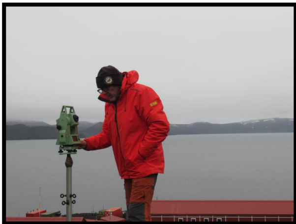
Amós realizando mediciones con la estación total
