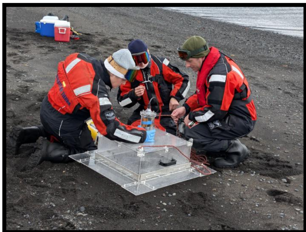
Rute, Catarina y Javier Abizanda instalando el motor a la cámara de flujo
