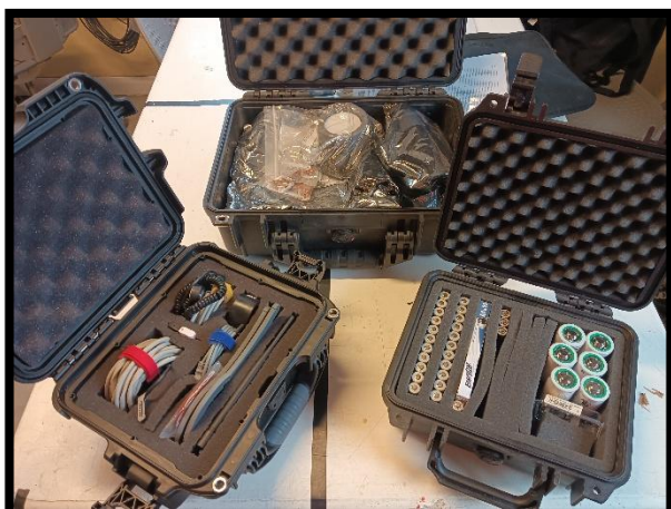
Maletines con cables, pilas y sensores de repuesto para el mantenimiento de las estaciones PERMTAHERMAL que queda de respaldo en la BAE GdC
