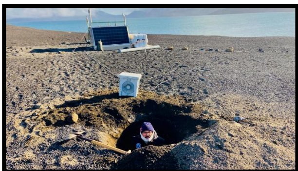
Jorge realizando un sondeo para la instalación de un sensor sísmico
