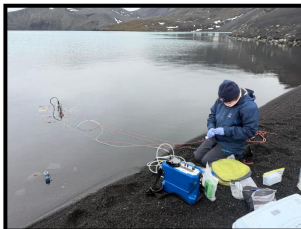
Catarina sacando muestras de agua, con la bomba peristáltica
