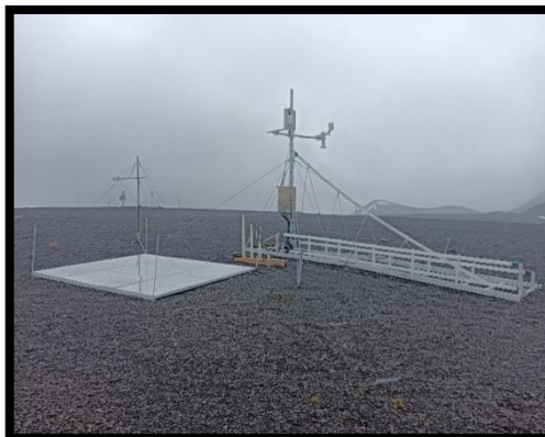
Reactivación y descarga de datos de la estación nivométrica situada en el entorno de Crater Lake, tras la reinstalación de la batería
