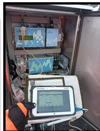
Reactivación y descarga de datos de la estación nivométrica situada en el entorno de Crater Lake, tras la reinstalación de la batería
