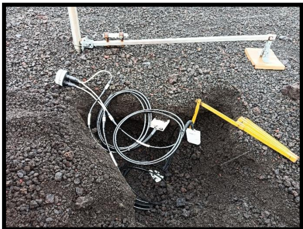
Instalación de sensores de humedad del suelo a distintas profundidades en una de las estaciones de la red PERMATHERMAL
