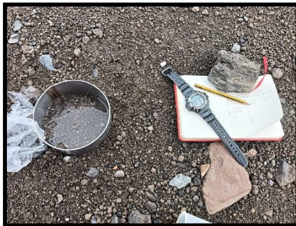
Experimento para la medida de la infiltración de agua en el suelo realizados en la estación de Cerro Caliente
