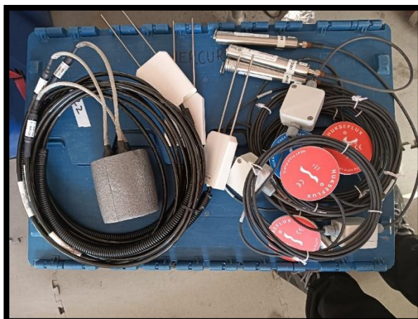
Preparación de sensores de nueva instalación para completar la instrumentación de las estaciones de la red PERMATHERMAL en la Isla Decepción
