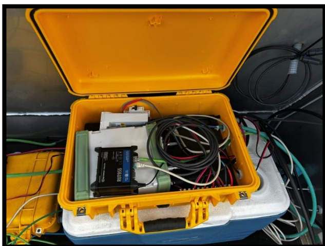
Equipo GNSS con el módulo de emisión de radio cambiado
