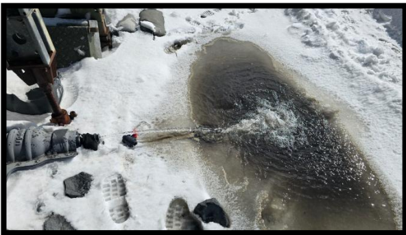
Llave de paso de la red de agua reventada por el hielo
