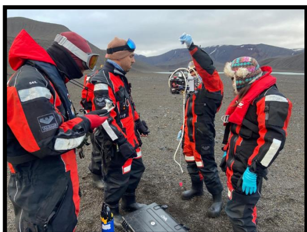
Alejandro y Susana preparando la bomba de metales asociada al dron para la filtración "in situ"
