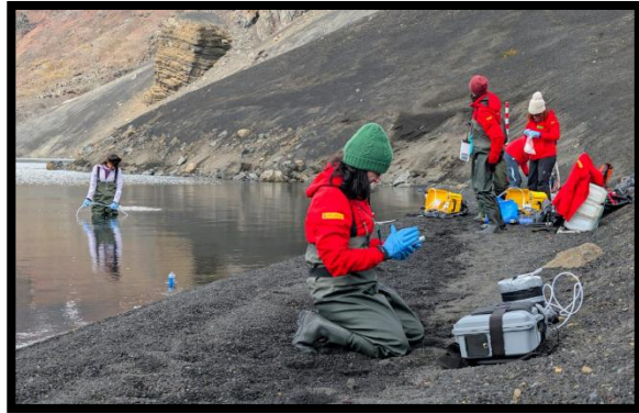
Estación 1 en el lago Cráter . Susana en primer plano con el dispositivo de medida de gases LI- COR para CO2 y metano
