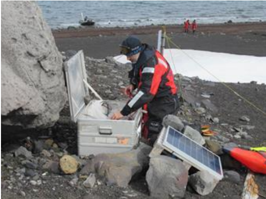
Revisión estación sísmica RON
