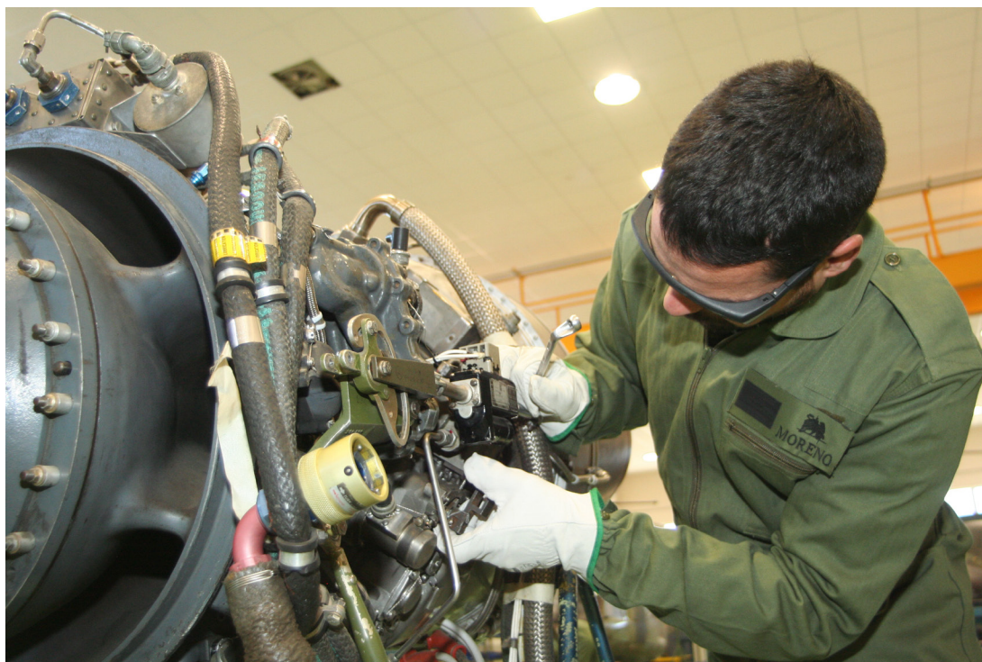
Sargento alumno reparando una turbina de un helicóptero
