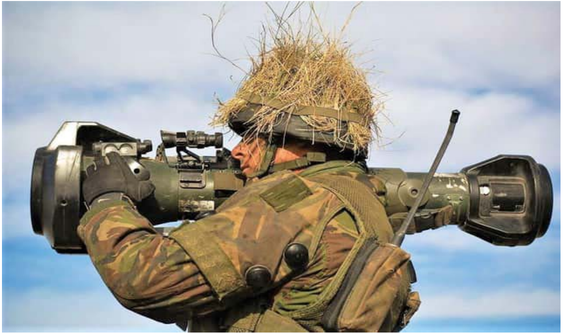
Soldado británico con NLAW, se puede apreciar la óptica de puntería del sistema (Saab)
