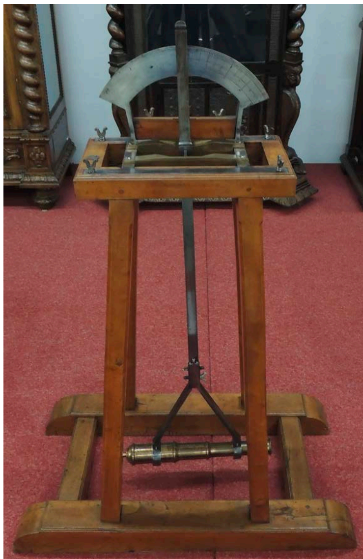
Caballero de Arcy. Ingenio del s. XVIII, modificado por la ordenanza de 1802, usado para realizar pruebas de potencia de pólvora. Museo militar de La Coruña (Fotografía del autor).
