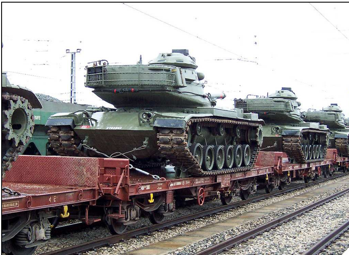
Plataformas ferroviarias de transporte, sobre las que se ubicará y transportará el diferente material de combate asignado al convoy.
