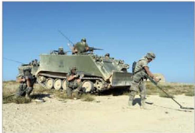
El paso del detector garantiza la seguridad en el avance del vehículo
