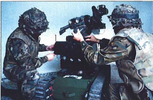
Todos los elementos del Teodor son electrónicos y modulares
