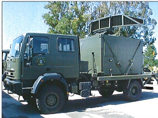
La dirección de tiro está instalada en dos contenedores fácilmente transportables
