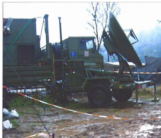
En el campamento de Arja, en Pakistán, se instaló un importante sistema de comunicaciones. A la derecha, el terminal satélite tipo I (ASTURIAS-D) en una operación
