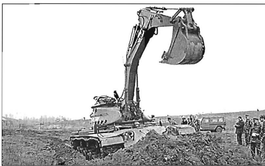
El primer carro de zapadores puede abrir zanjas de 2,65 m de profundidad
