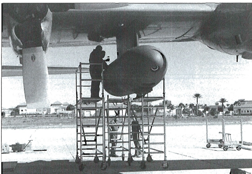
Una de las ventajas del COPS es que puede ser instalado en cualquier avión Hércules en poco más de cuatro horas.
